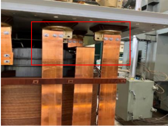
Şekil 3. Buşinglerin etkisini ortadan kaldırmak için kullanılan ölçüm noktaları
