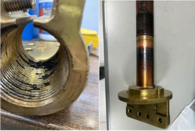
Şekil 8. Hasarlı terminallerin görüntüsü
