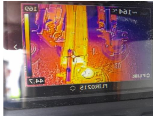
Şekil 2. Aşırı ısınmanın gözlemlendiği alçak gerilim buşinglerinin termal kamera görüntüleri
