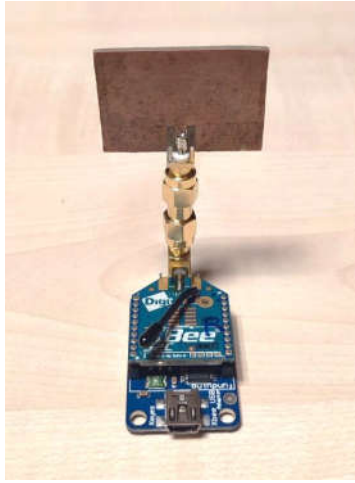
Şekil 4. Mikroşerit anten takılmış XBee
