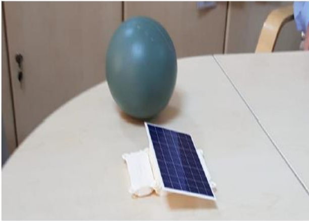
Şekil 10: Burdur Gölü’nde Buharlaşma Önlemi Olarak Kullanılacak Olan Polietilen Top ve Modüler Güneş Paneli
