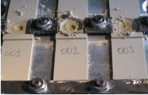
Şekil 3. SKNK için geliştirilen bağlama aparatı
