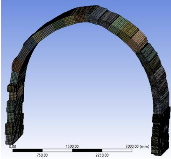
Şekil 4. Kemerli Yapıda Oluşan Mesh Yüzeyler
